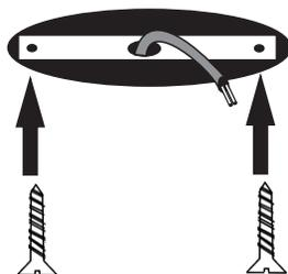
Fixe no teto a chapa de fixação da canopla de acabamento e passe os fios da rede no furo central
