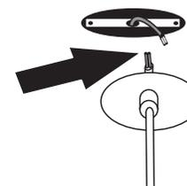
Com a rede elétrica desligada, conecte os fios do driver e isole com fita isolante anti-chamas.
